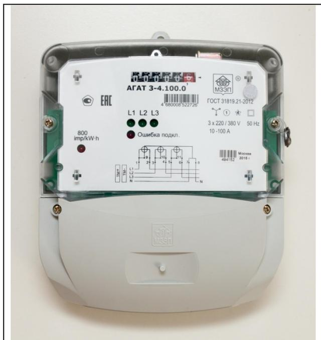
**Счетчики трехфазные однотарифные** в корпусе К4 с креплением на три винта. Счетчик содержит в качестве счетного механизма электромеханическое отчетное устройство, которое одновременно выполняет функции запоминающего устройства. Имеют класс точности 1, ток 100А, номинальное напряжение 3х220/380В. Счетчики имеют защиту от распространенных приемов хищения электроэнергии, а также от воздействия электромагнитного поля. Предельный рабочий диапазон температур от минус 40 до плюс 60 °С.
