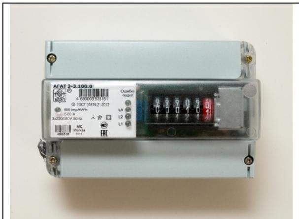
**Счетчики трехфазные однотарифные** в корпусе К3 с креплением на DIN-рейку. Счетчик содержит в качестве счетного механизма электромеханическое отчетное устройство, которое одновременно выполняет функции запоминающего устройства. Имеют класс точности 1, ток 100А, номинальное напряжение 3x220/380В. Счетчики имеют защиту от распространенных приемов хищения электроэнергии, а также от воздействия электромагнитного поля. Предельный рабочий диапазон температур от минус 40 до плюс 60 °С.
