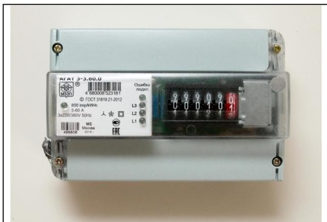
**Счетчики трехфазные однотарифные** в корпусе К3 с креплением на DIN-рейку. Счетчик содержит в качестве счетного механизма электромеханическое отчетное устройство, которое одновременно выполняет функции запоминающего устройства. Имеют класс точности 1, ток 60А, номинальное напряжение 3х220/380В. Счетчики имеют защиту от распространенных приемов хищения электроэнергии, а также от воздействия электромагнитного поля. Предельный рабочий диапазон температур от минус 40 до плюс 60 °С.
