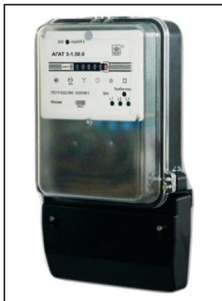
**Счетчики трехфазные однотарифные** в корпусе К1 с креплением на три винта. Счетчик содержит в качестве счетного механизма электромеханическое отчетное устройство, которое одновременно выполняет функции запоминающего устройства. Имеют класс точности 1, ток 50 А, номинальное напряжение 3х220/380В. Счетчики имеют защиту от распространенных приемов хищения электроэнергии, а также от воздействия электромагнитного поля. Предельный рабочий диапазон температур от минус 40 до плюс 60 °С.
