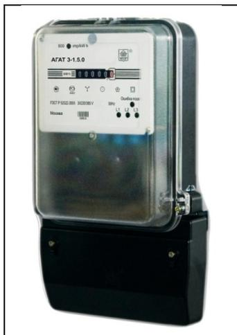
Счетчики трехфазные однотарифные в корпусе К1 с креплением на три винта. Счетчик содержит в качестве счетного механизма электромеханическое отчетное устройство, которое одновременно выполняет функции запоминающего устройства. Имеют класс точности 1, ток 7,5 А, номинальное напряжение 3x220/380В. Счетчики имеют защиту от распространенных приемов хищения электроэнергии, а также от воздействия электромагнитного поля. Предельный рабочий диапазон температур от минус 40 до плюс 60 °С.
