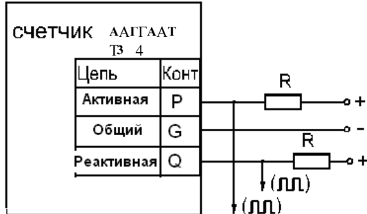
Рис. 4.5 Схема подключения импульсных выходов
