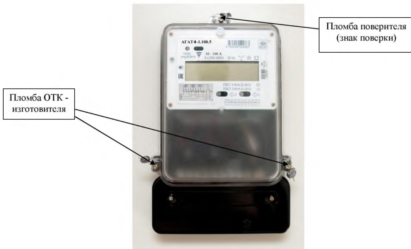
Рисунок 1 - Общий вид счетчиков в корпусе К1, схема пломбировки от несанкционированного доступа и обозначение места нанесения знака поверки
